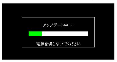
(4) アップデートが終了すると完了表示され、SLOT A LED と SLOT B LED がゆっくりと同時点滅します。
